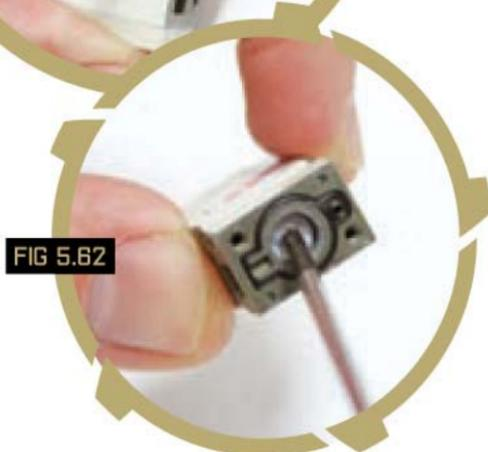
Nettoyez entièrement et vérifiez les joints toriques et le piston **[VOIR FIGURE 5.63]**. Lubrifiez les joints toriques avec de la graisse Dow 33 ou équivalente et réinsérez le piston dans le corps de l'électrovanne, la face concave orientée vers la face A du corps de l'électrovanne.
