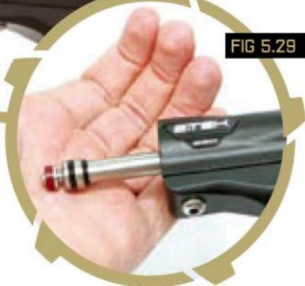
Lubrifiez tous les joints du rammer et replacez le à l'arrière du corps du Etek Ego avec le tampon vers l'arrière [VOIR FIGURE 5.33].
